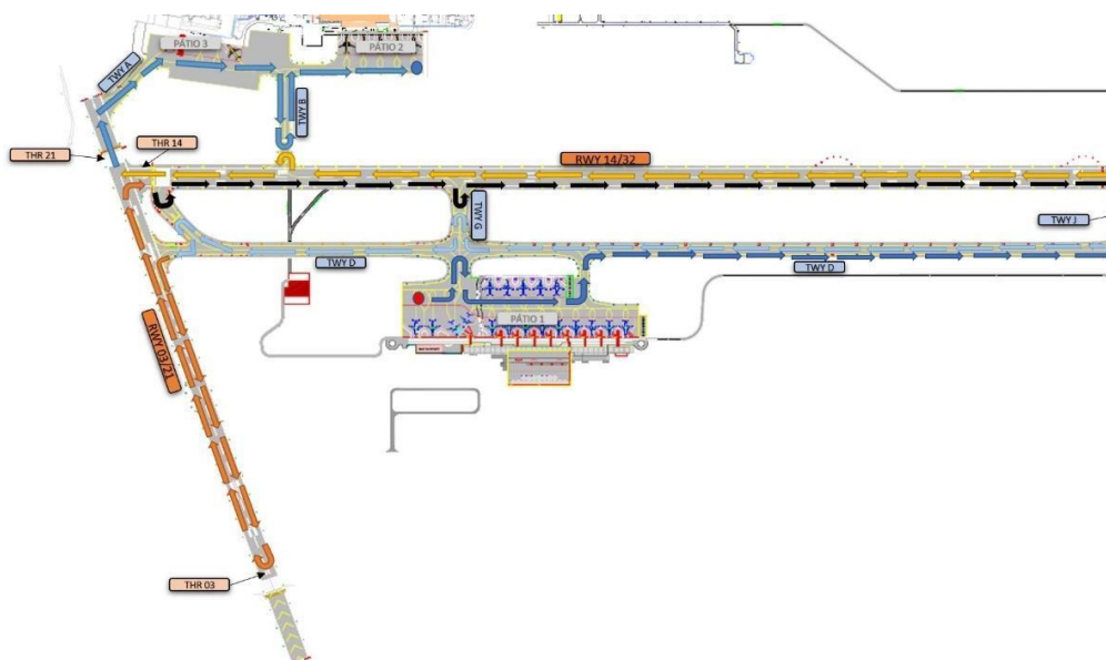
Figura 14 – Rota para inspeções de pista com drone.
